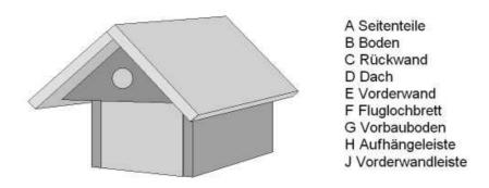
Vorderfront kann zur Kontrolle über den Drehpunkt nach oben hochgeklappt werden. Brettstärke 2 cm, alle Maße in Zentimeter.
